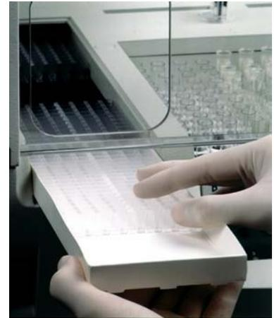
La zona di caricamento delle cuvette, insieme a tutte le altre zone di lavoro (campionamento, incubatore, reagenti, modulo ottico) è protetta da una copertura rigida in plexiglas trasparente, che consente di osservare la regolarità di svolgimento delle operazioni e contemporaneamente garantisce la sicurezza dell'operatore.
