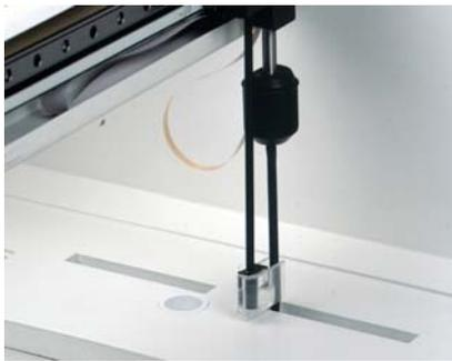
La zona di campionamento, insieme a tutte le altre zone di lavoro (incubatore, reagenti, modulo ottico), è protetta da una copertura rigida in plexiglas trasparente, che consente di osservare la regolarità di svolgimento delle operazioni e contemporaneamente garantisce la sicurezza dell'operatore. L'unità campionatrice è costituita da due circuiti separati per campioni e reagenti; l'aspirazione dei campioni è eseguita da un ago termostato, con sensore di livello, e da una
